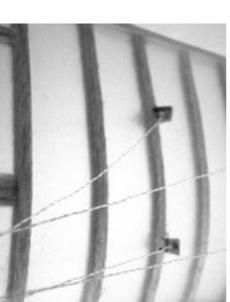
Dispositif de fixation des haubans
