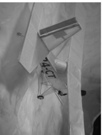
Gros plan sur l'empennage, avec l'emplacement destiné au bobinage, qui n'est pas encore installé
