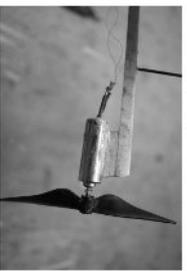
La propulsion est assurée par un pager Didel (MK04-10 4mmx11mm Pager130hms) dont l'axe de 0,7mm s'adapte bien à l'hélice Plantraco Plastic Prop 32mm.
