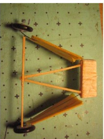
Détail du train d'atterrissage, seule la partie en corde à piano est fonctionnelle.
